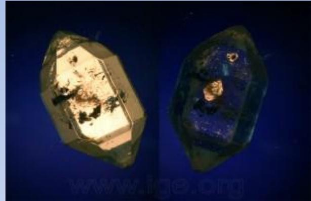
Inclusão de quartzo em quartzo, observada entre polarizadores cruzados devido à diferente orientação em função do hospedeiro
