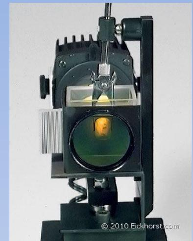
A fonte de luz é de alta intensidade de 12 volts / 20 Watt. Lâmpada de halogênio para iluminação potente. Diafragma de Iris para ajustar a intensidade de luz e focagem.
